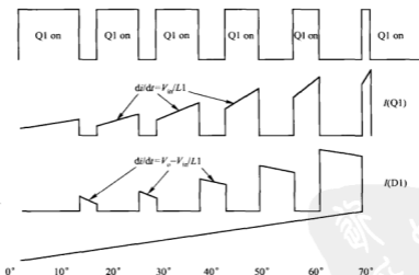
图 15.4 图 15.3 所示的 Boost 变换器在正弦半波输入电压各点对应的电流波形图
